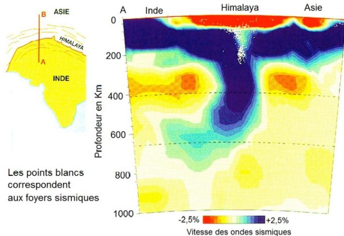
La tomographie sismique est une technique permettant de visualiser en profondeur les variations de la vitesse de propagation des ondes sismiques.
